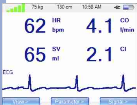
Schermo di controllo: visualizzazione di 4 dati emodinamici ed 1 forma d'onda.
